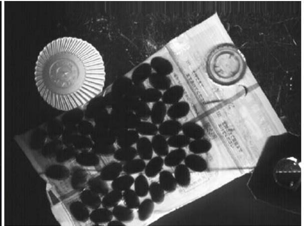
Swir-Licht durchdringt für Menschen undurchsichtiges Plastik und Glas. Die Sweep+-Kamera von JAI kann daher auch kontrollieren, ob sich Verunreinigungen in Verpackungen, wie hier von Nüssen, befinden. Gleichzeitig zeigt sich im sichtbaren Licht, ob die Beschriftung der Tüte korrekt und die Qualität in Ordnung ist.
