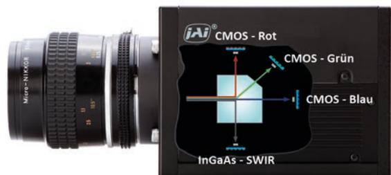
Diese Zeilenkamera verfügt über drei CMOS- und einen InGaAs-Sensor und kann Swir- und sichtbares Licht zeitgleich erfassen.
