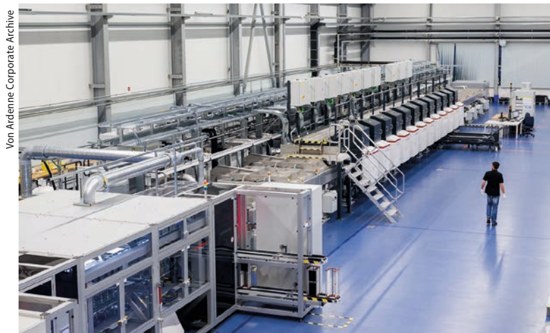
Abb. 5 Silizium-Wafer-Vakuumbeschichtungsanlagen können bis zu 10 000 Wafer pro Stunde beidseitig beschichten.
