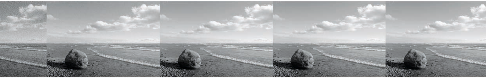
▲ Das Schrotrauschen lässt sich anhand eines Beispielfotos illustrieren: Die Zahl der Photonen pro Pixel nimmt von links nach rechts um jeweils eine Größenordnung zu: beginnend mit 10^{-3} Photonen pro Pixel bis zu 10^5 Photonen pro Pixel. In der Mitte (10 Photonen pro Pixel) steigt die Bildqualität sprunghaft an.
