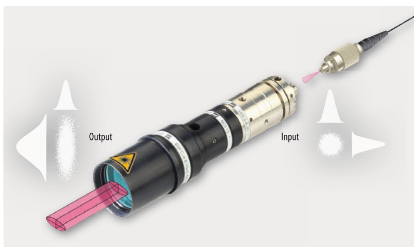
Abb. 6 Ein elliptischer Faserkollimator für zweidimensionale magneto-optische Fallen. Für die Umformung des aus der Faser tretenden runden Strahls in einen elliptischen Strahl mit Seitenverhältnis 1:3 wird ein Zylinderlinsen-Teleskop vom Typ 5AN eingesetzt.
