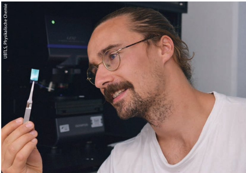
Der Sensor zeigt intensive Farben bei niedriger Umgebungstemperatur.
