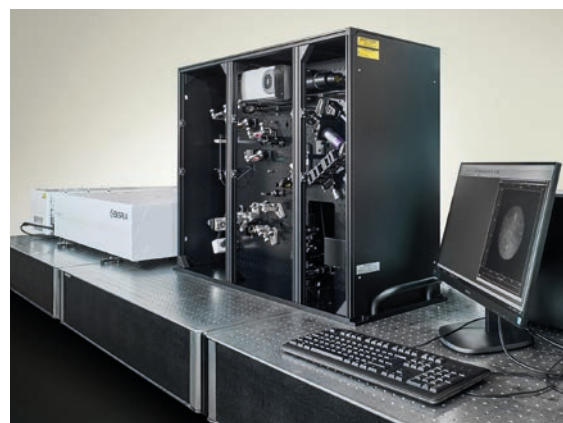
Abb. 2 Das SFG-Spektrometer – klassisches und Mikroskopie-Setup in einer Einheit.
