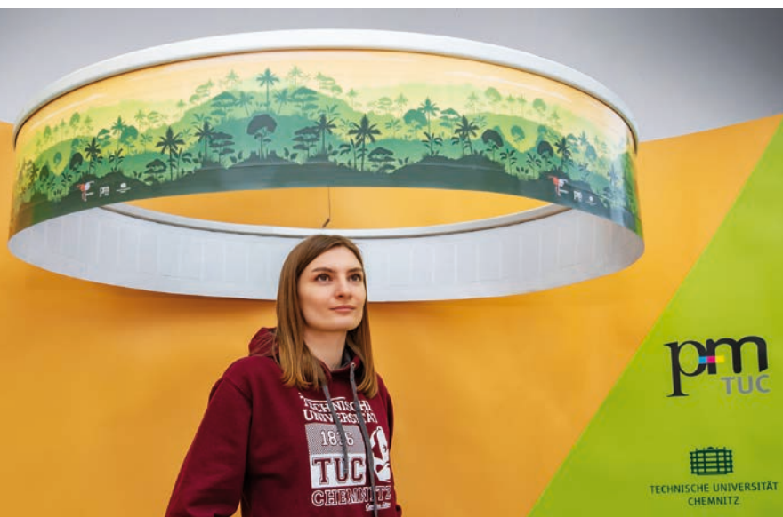
Surround-Sound aus rollengedruckten Piezolausprechern: Das Papiersubstrat lässt sich auf der Rückseite farbig bedrucken.
