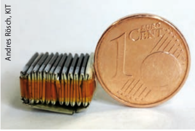
Die gefalteten thermoelektrischen Generatoren bilden einen winzigen Kubus.
