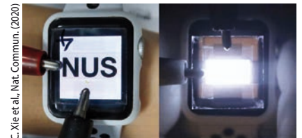
Die Perowskit-LED, hier platziert auf einem Smartwatch-Display, besitzt eine hohe Transparenz und starke Emission (links: sichtbares Licht, rechts: NIR).
