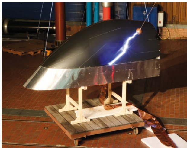
Abb. 6 Beim Hochspannungstest eines Satcom-Radomes beträgt die Ladungsspannung des Generators rund 1,2 Megavolt.
