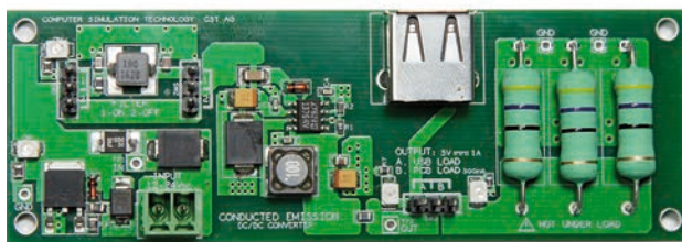
Abb. 2 Das Foto links zeigt die bestückte Leiterplatte eines Bulk Step-Down DC/DC Converters. Rechts sind die Ergebnisse einer nichtlinearen Schaltungssimulation gekoppelt mit 3D-Feldberechnung zu sehen. Stellen mit hoher Stromdichte (rot) und damit hoher magnetischer Feldstärke könnten EMV-Probleme verursachen.
