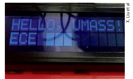
Der Nanodrahtgenerator konnte ein LC-Display mit Strom versorgen.
