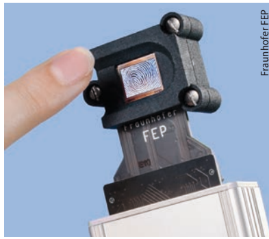
Bidirektionale Displays können Fingerabdrucksensoren von Biofilmen befreien.
