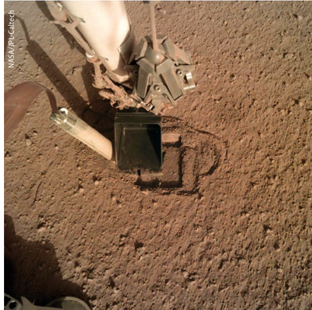
Auch mit Unterstützung des Greifarms von Mars InSight konnte der „Maulwurf“ des DLR nicht ausreichend tief unter die Marsoberfläche gelangen.
