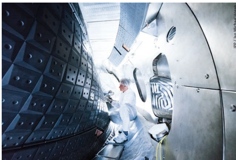
Das Divertorsystem bei Wendelstein 7-X ist aus Graphitkacheln (links) aufgebaut.
