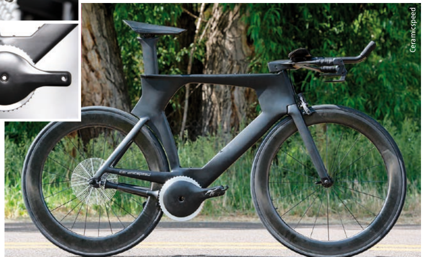
Abb. 1 Der „Driven“-Antrieb besteht aus einer Welle aus Carbon, an deren Enden Kegel mit einem Kranz aus jeweils 21 Kugellagern sitzen. Zum Antrieb greift der Kugellagerkranz in das hintere Zahnrad.
