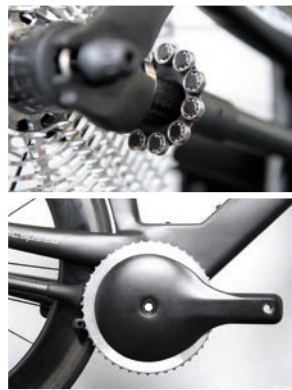
Abb. 1 Der „Driven“-Antrieb besteht aus einer Welle aus Carbon, an deren Enden Kegel mit einem Kranz aus jeweils 21 Kugellagern sitzen. Zum Antrieb greift der Kugellagerkranz in das hintere Zahnrad.
