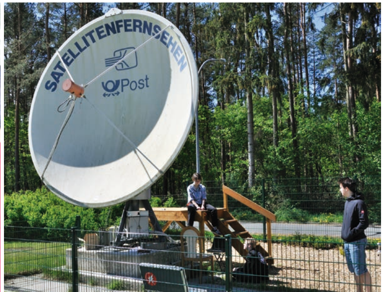
Abb. 3 Der als Teamprojekt in fünf Jahren umgebaute Reflektor bildet das Herzstück eines Radioteleskops.
