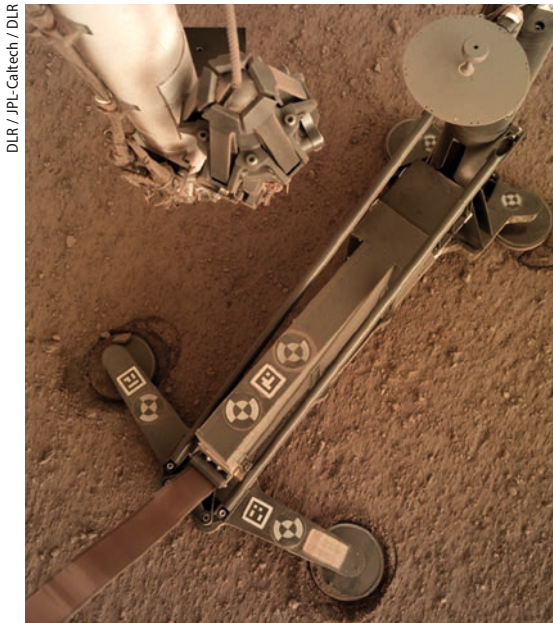
Dieses Foto der Wärmeflusssonde HP 3 auf dem Marsboden zeigt oben links Teile des Gehäuses der Rammsonde.
