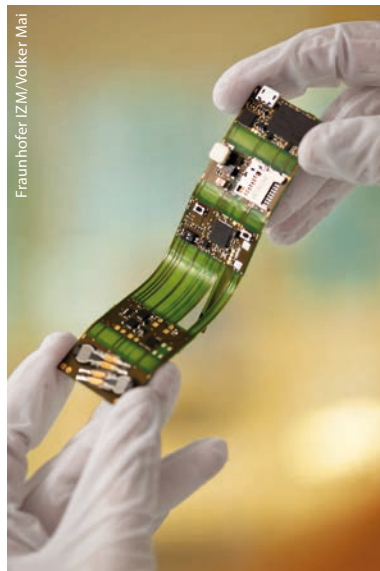
Beispielhaftes Layout der Elektronik für ein Armband zur Demenzfrüherkennung
