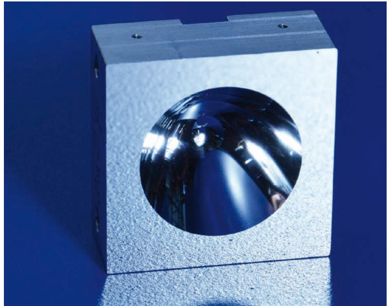
Dieser sehr tiefe Parabolspiegel soll auf ein einzelnes Atom ein Wellenpaket fokussieren, das in der gleichen räumlichen Mode wie ein spontan von einem Atom ausgesendetes Lichtteilchen präpariert ist.
