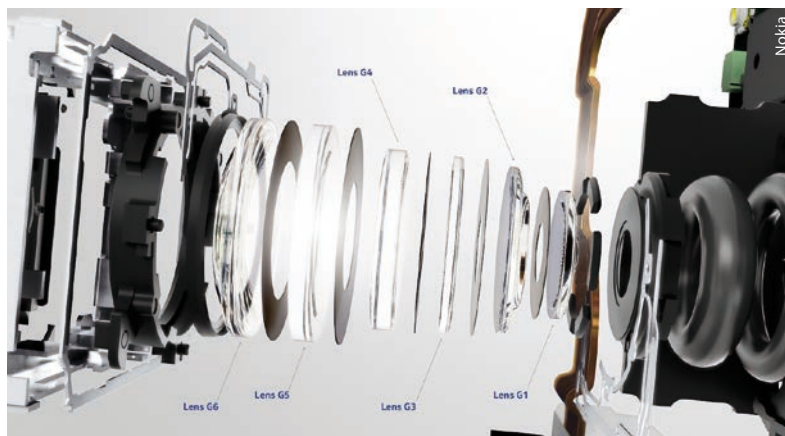
Abb. 1 Sechs Linsen, ein optischer Bildstabilisator und nur fünf Millimeter dick – so sehen moderne Smartphone-Optiken aus.
