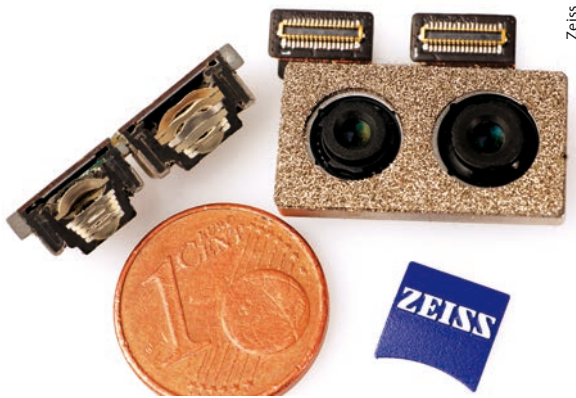
Abb. 2 Um auf kurzer Distanz große Brechkraft zu erzeugen, sind die Linsen stark asphärisch geformt. Das Gehäuse mit dem Linsenpaket lässt sich zur Fokussierung verschieben.
