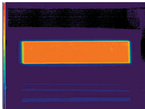
Abb. 1: Die Energieverteilung eines homogenisierten Excimer-Lasers zeigt eindrucksvoll, wie scharf sich das Strahlprofil begrenzen lässt – hier auf eine Fläche von 10 mm × 50 mm –. (Quelle: MicroLas Lasersystem GmbH)
