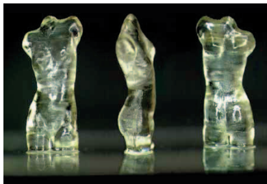
Die Miniatur-Kopie der Venus ist 0,5 cm hoch und soll nur der Anschauung dienen. Mit dem neuen Laser-Verfahren wollen die Physiker 10 Mikrometer kleine Strukturen fertigen. (Quelle: LZH)
