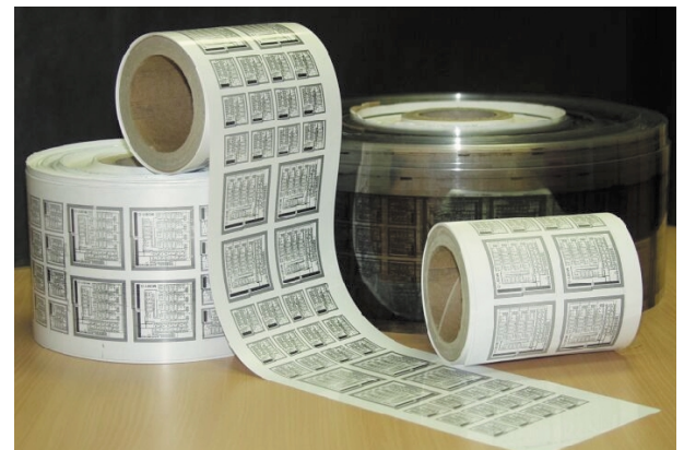
Abb. 6: Testmuster einer Leiterbahnebene, also einer wichtigen Funktionsschicht eines Plastik-Chips, die aus elektrisch leitender Druckfarbe in einem Rolle-zu-Rolle Offset-Verfahren gedruckt wurde.
