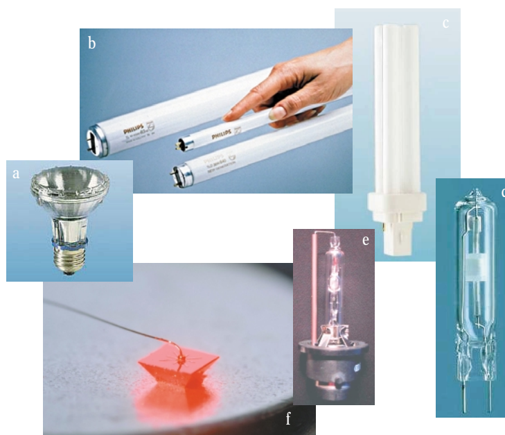
Abb. 1: Heute sind viele verschiedene Lampentypen auf dem Markt. Prinzipiell wird Licht jedoch nur auf drei Arten erzeugt: erstens durch Strahlungsemission eines Festkörpers im thermischen Gleichgewicht (a: Halogen- oder Glühlampe), zweitens durch Stoßanregungen von Atomen, Ionen oder Molekülen in der Gasphase
