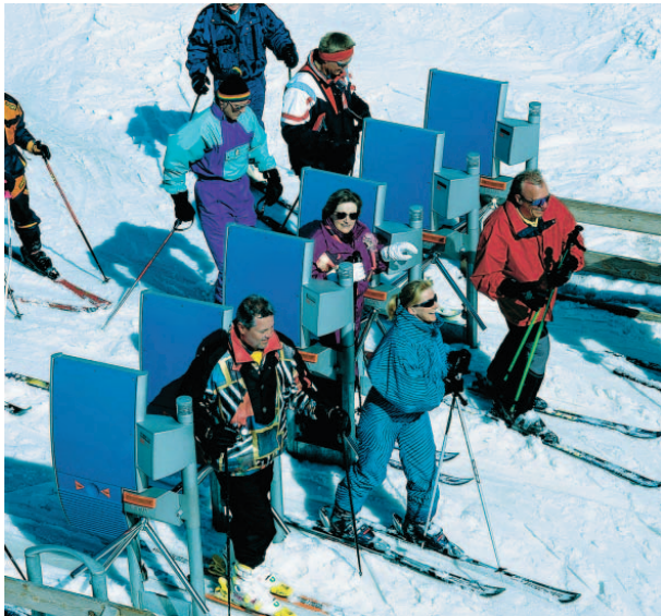
Abb. 1: Dank kontaktloser Zugangskontrolle können die Liftkarten in der Jacke und die Hände in den Handschuhen bleiben. (Quelle: Skidata)
