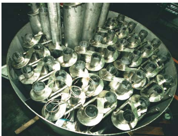
Dieses Experiment im Forschungszentrum Karlsruhe dient zum Nachweis des Dynamoeffekts im Labor: Flüssiges Natrium durchströmt die insgesamt 52 Rohre innerhalb des großen Zylinders und erzeugt so ein selbsterregtes Magnetfeld.
