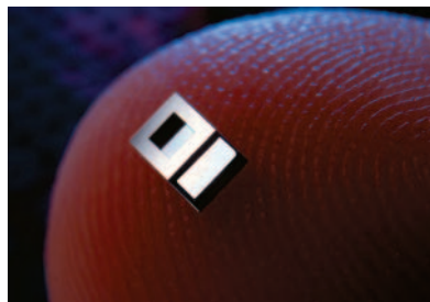
Forscher aus Dänemark bauen winzige Kondensatormikrofone aus Silizium und integrieren diese zusammen mit den zur Signalverarbeitung notwendigen Bauelementen auf einem Chip. Diese Mikrofon-Chips sind nur ein Zehntel so groß wie handelsübliche Kleinstmikrofone. (Quelle: Sonion)
