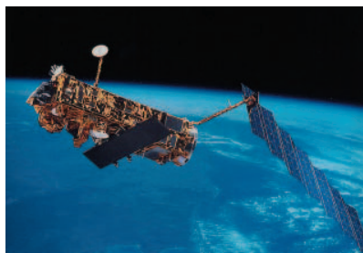
In 100 Minuten umrundet ENVISAT die Erde. Dabei funkt der Satellit 140 Gigabit Messdaten zur Erde. (Quelle: ESA)
