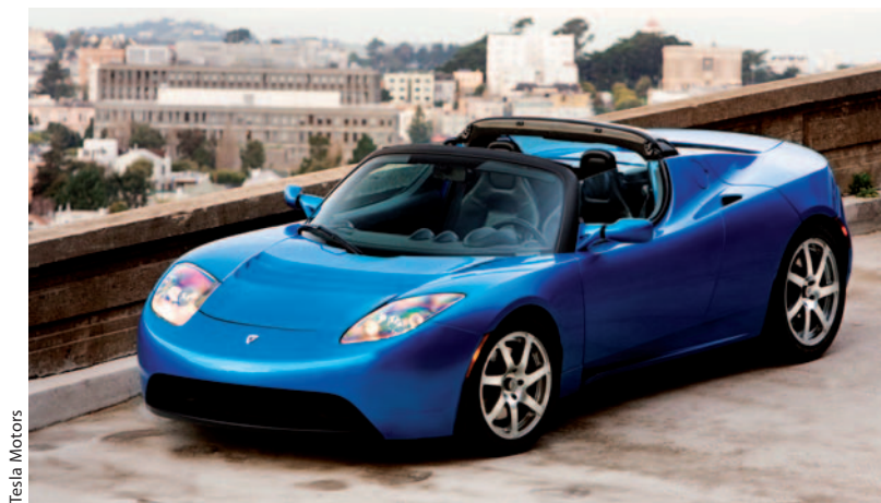
Abb. 5 Das Elektroauto Tesla Roadster erreicht mit konventionellen Lithium-Ionen-Akkus eine Reichweite von 350 Kilometern.
