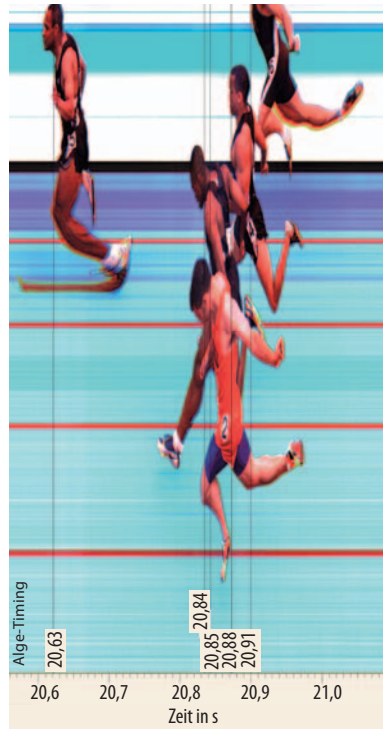
Abb. 2 Die Hochgeschwindigkeitskamera scannt in extrem kurzen Zeitintervallen die Ziellinie ab. Setzt man diese Einzelscans zu einem Bild zusammen, erkennt man links leicht den Sieger des Rennens.
