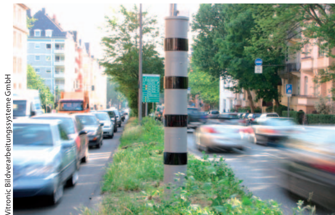
Abb. 2 Eine Poliscan-Säule auf einem Grünstreifen überwacht mit einer Ausleuchtung von etwa 45 Grad den Verkehr auf bis zu drei Fahrbahnen pro Richtung.
