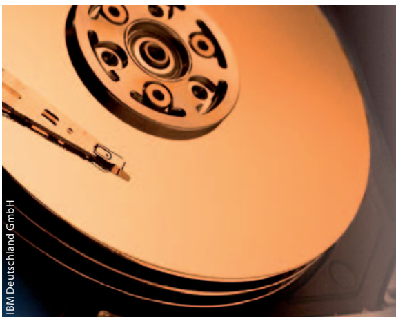
Dank des GMR-Effekts ist die Speicherdichte von Computer-Festplatten rasant gewachsen.
