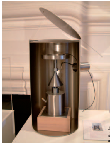
Nachbau eines von Elster und Geitel konstruierten Geräts zur Messung der Elektrizitätsentwicklung bei Regen.
