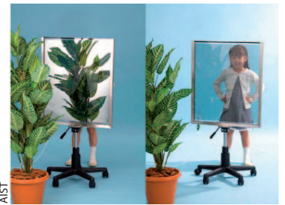
Links Spiegel, rechts Fenster: Durch Zuführen von Wasserstoff oder Sauerstoff lässt sich das Fenster umschalten.
