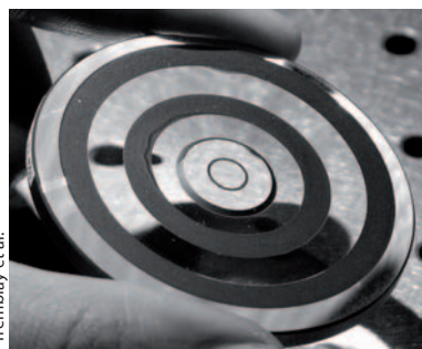
Ansichten einer integrierten Kamera: Ihr Herzstück bildet ein oberflächenstrukturierter Kalziumfluorid-Kristall.
