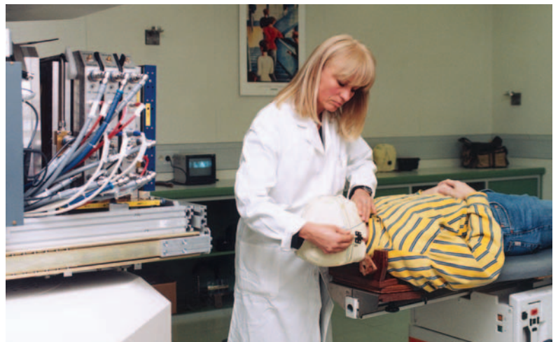
Für eine hochpräzise Schwerionentherapie von Hirntumoren muss der Kopf des Patienten fixiert werden. Links ist das Ende des Strahlrohrs mit den Monitoreinheiten zu sehen.
