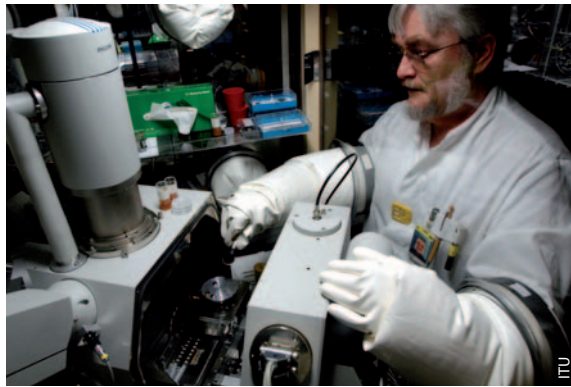
Um radioaktive Proben untersuchen zu können, befindet sich dieses Rastertunnelmikroskop am Institut für Transurane in Karlsruhe innerhalb eines Handschuhkastens.
