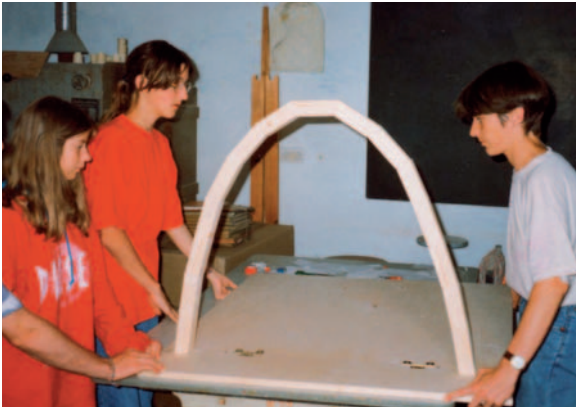
Ein weiteres Beispiel für eine Experimentierstation mit „Physik zum Anfassen“: Eine Brücke in Form einer auf dem Kopf stehenden Kettenlinie bleibt auch ohne Klebstoff stabil.
