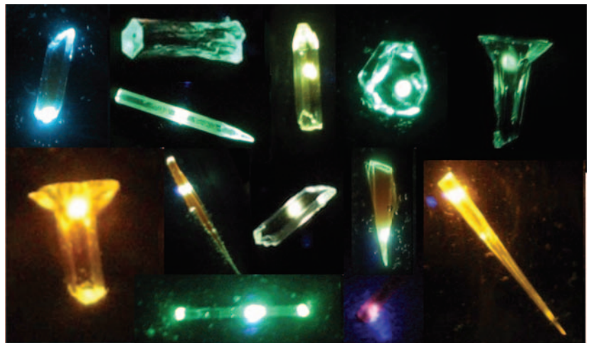
ZnO-Kristalle, die im UV bei 77 K angeregt werden, leuchten je nach Dotierung
