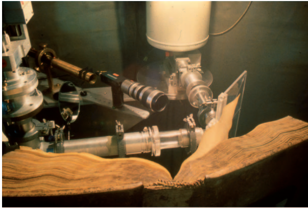
Abb. 4: Diese Apparatur erlaubt es, die durch Synchrotronstrahlung induzierte Röntgenfluoreszenz von Druckerschwärze zerstörungsfrei zu messen. Der Elektronenstrahl trifft von links auf die Inkunabel, unter einem Winkel von 90° steht der Röntgen-detektor. Die vermessene Position lässt sich mit einer Videokamera aufzeichnen.
