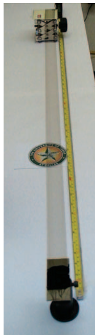
Aus Nanoröhrchen lassen sich nun meterlange Bänder herstellen, die äußerst dünn, transparent und reißfest sind. (Foto: Zhang, et al., Univ. of Wisconsin)
