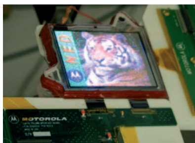
Dieser Prototyp eines Displays auf Basis von Nanoröhrchen hat eine Bilddiagonale von 5 Zoll. (Foto: Motorola)
