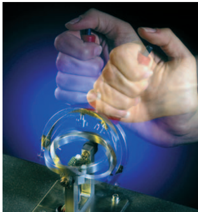
Die genaue Position eines Bremspedals oder eines Joysticks lässt sich mithilfe eines neuen Sensors direkt bestimmen. (Foto: FHG)
