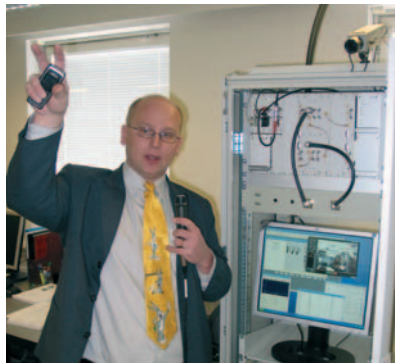
Noch ist dieser Prototyp für den Mobilfunk der vierten Generation groß wie ein Kühlschrank, aber Übertragungsraten von 50 Mbit/s wurden damit schon erreicht. (Foto: J.-O. Löffken)
