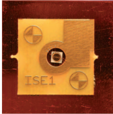
Diese Solarzelle, bestehend aus mehreren Schichten aus Verbindungshalbleitern, hat einen Wirkungsgrad von 35 %. (Foto: ISE)
