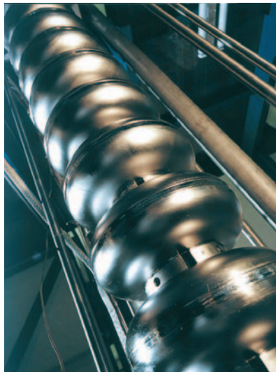
Zentrale Bestandteile des International Linear Collider werden die bei DESY in Hamburg entwickelten supraleitenden Beschleunigerstrukturen aus Niob sein. (Foto: DESY)
