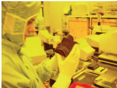
Begutachtung einer Photomaske im Reinraum. (Foto: IHF, TU Braunschweig)
