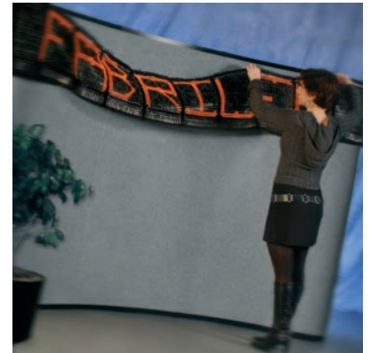
Ein flexibler „Monitor“ der besonderen Art ist diese Stoffbahn mit eingewobenen Leuchtdioden. (Foto: FabriLED)
