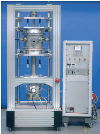
Eine räumliche Auflösung im Nanometer-Bereich soll das mit extrem ultraviolettem Licht betriebene Nanoskop ermöglichen (Foto: ILT)
