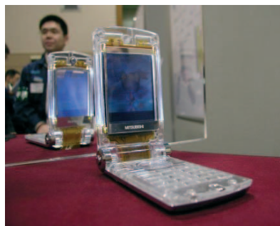
Dieses zweiseitige LCD-Display ist in der Lage, auf der Vorder- und Rückseite gleichzeitig unterschiedliche Bilder darzustellen. (Foto: Mitsubishi)
