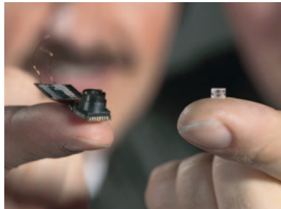
Diese winzige flüssige Linse könnte flexibles Fokussieren auch bei Kleingeräten wie Fotohandys ermöglichen. (Foto: Philips)
