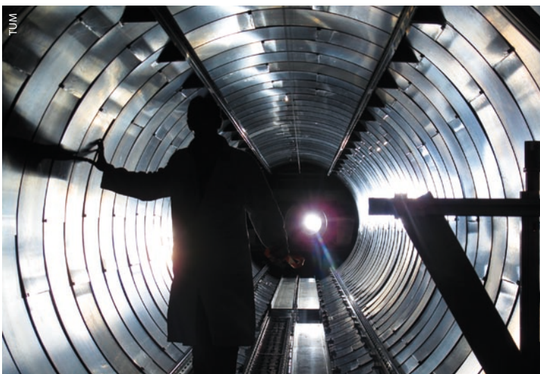
Blick ins Innere des „Small Angle Neutron Scattering“-Diffraktometers (SANS-1) während des Aufbaus an der
