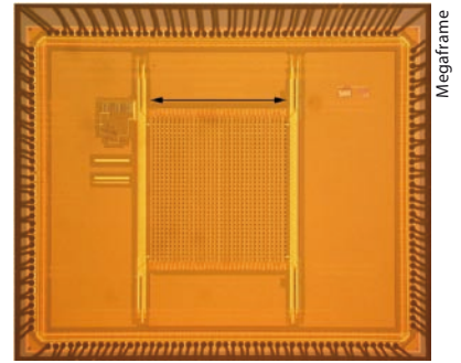
Der SPAD-Chip (hier ein Exemplar der ersten Generation) detektiert das schwache Licht, das bei der Fluoreszenzlebensdauer-Mikroskopie entsteht.
