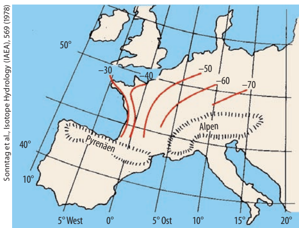
Abb. 1 Die isotopische Zusammensetzung des Grundwassers ändert sich in Europa mit der Entfernung vom Meer. Die eingezeichneten Isolinien (rot) geben die Abweichungen des Isotopenverhältnisses Deuterium/Wasserstoff im Grundwasser gegenüber diesem Verhältnis in einem standardisierten Meerwasser in Promille an.
