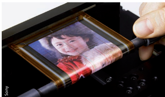
Selbst auf eine acht Millimeter dicke Rolle aufgewickelt, funktioniert dieses neuartige OLED-Display noch.
