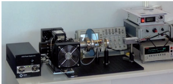
Das THz-Lasersystem von DLR und PDI wiegt nur 15 kg und eignet sich hervorragend für den mobilen Einsatz.
